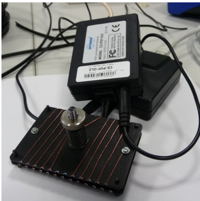
Obr. 4.12: Přípravek pro vytváření mikroohybů a dvojice POF převodníků.
