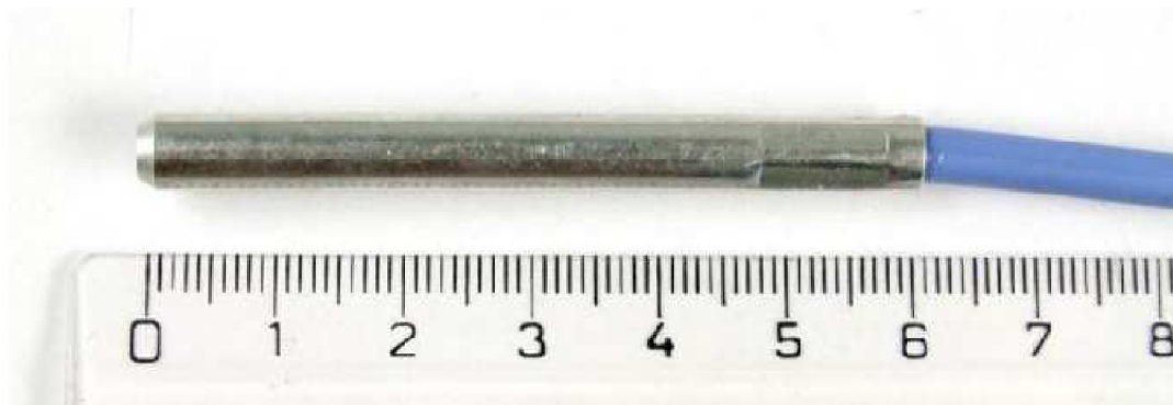
Obr. 1.1: Inteligentní teplotní čidlo TQS3 M
