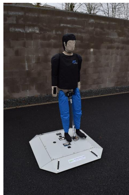
Obrázek 3: testovací platforma UFO s figurínou chodce.
