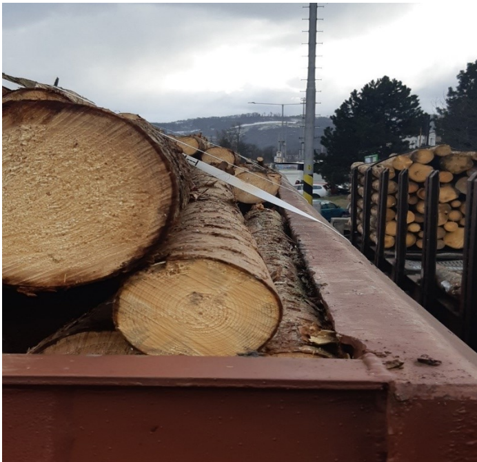
Obr. 2.6 Zajištěné dříví proti pohybu
