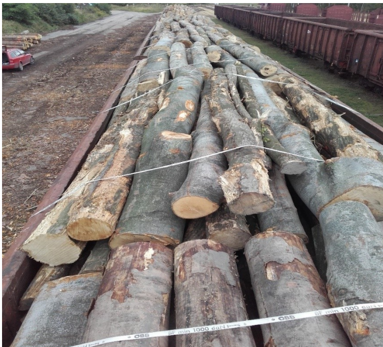
Obr. 2.7 Zajištění bukové vlákniny proti pohybu
