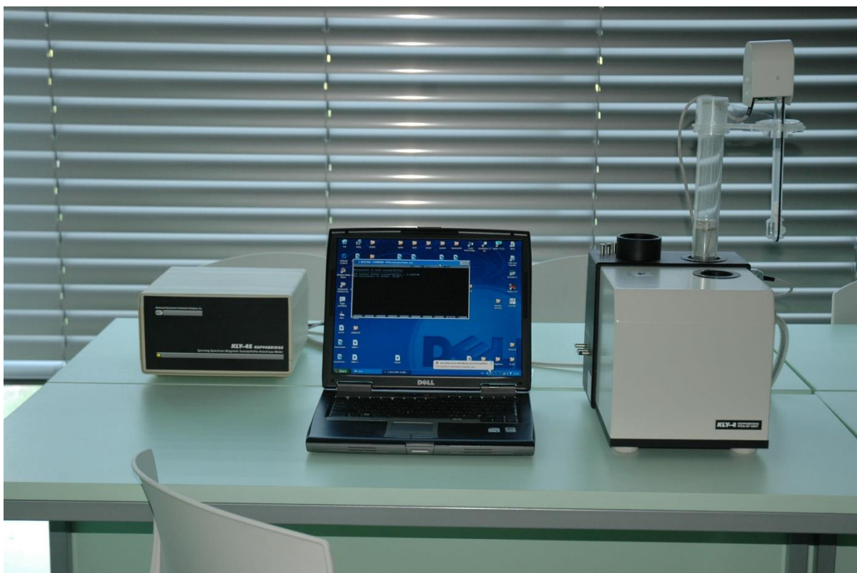
Obr. 12: Laboratorní kapamůstek KLY-4 (AGICO s. r. o., ČR) pro měření objemové magnetické susceptibilitu a anizotropie magnetické susceptibilitu minerálů a hornin (www8).
