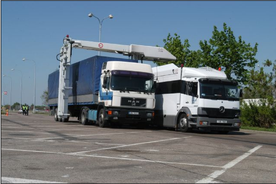
Obr. 12.1 Kontrola nákladního vozidla mobilním rentgenem[25]
