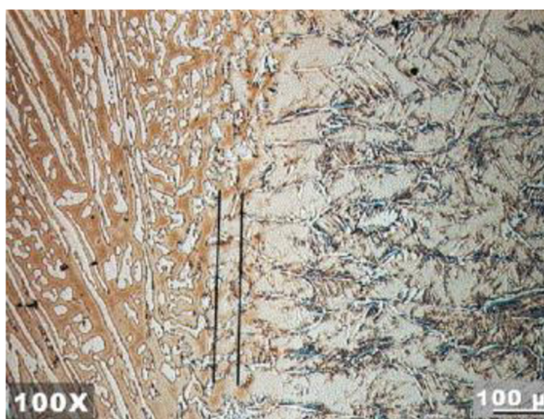
Obr. 1.2 Svarová a tepelně ovlivněná oblast [10].
