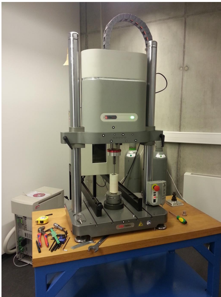
Obrázek 32: Měřicí zařízení ElectroPuls E1000 od firmy Instron
