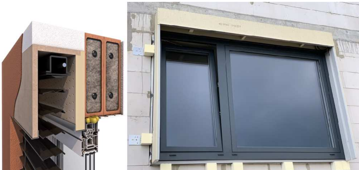
Obr. 17: Princip montáže a detailní řez purenitového boxu Labona s.r.o. (Brandejský a další, 2022b)
