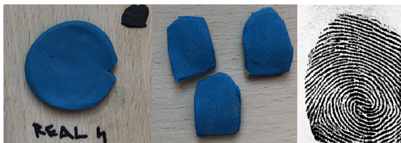
Obr. 4.4: Výroba plastelínových falzifikátov.
