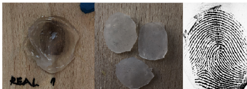
Obr. 4.5: Výroba silikónových falzifikátov.
