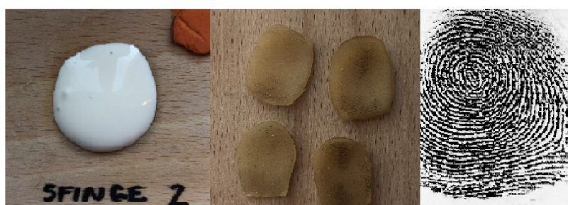
Obr. 4.6: Výroba latexových falzifikátov.
