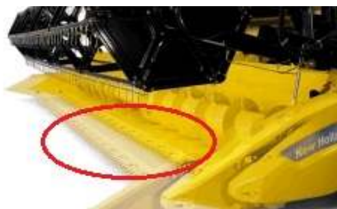
Obrázek 2/6 – Změna délky žacího stolu adaptéru Varifeed TM
