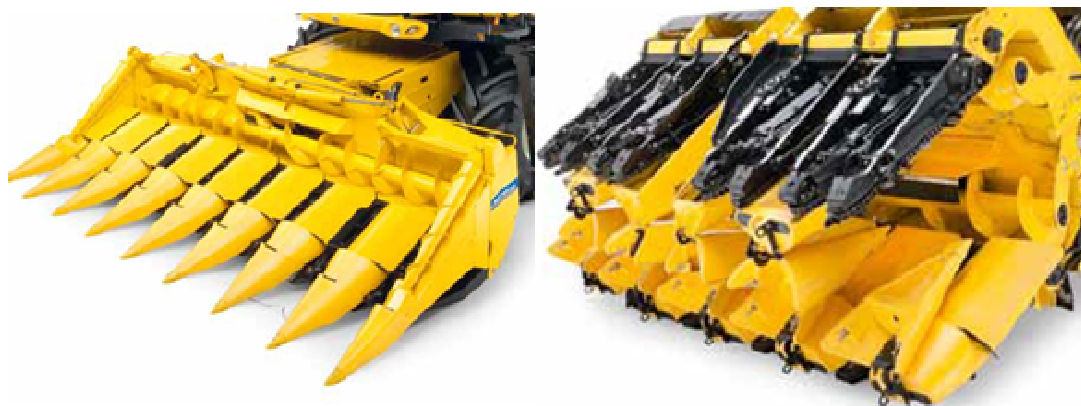
Obrázek 2/9 – Sklopný osmiřádkový adaptér na sklizeň kukuřice
