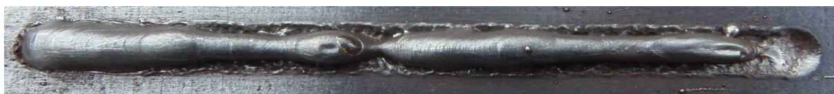
Obr. 43 Housenka č. 7 – směr vzad, impulsní přenos
