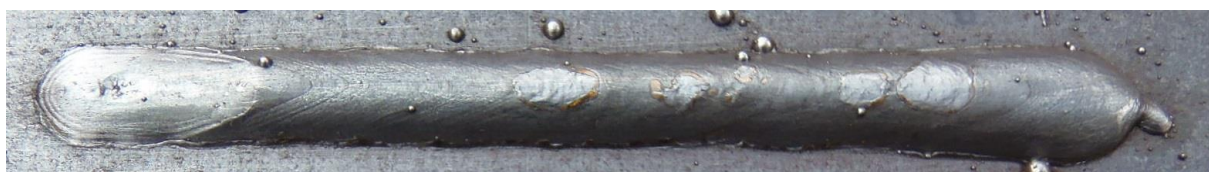
Obr. 32 Housenka č. 5 – směr vpřed, přechodový přenos
