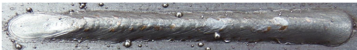
Obr. 30 Housenka č. 4 – směr vpřed, přechodový přenos
