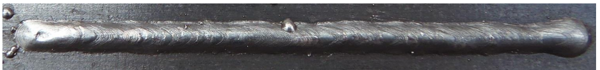
Obr. 28 Housenka č. 1 – směr vpřed zkratový přenos
