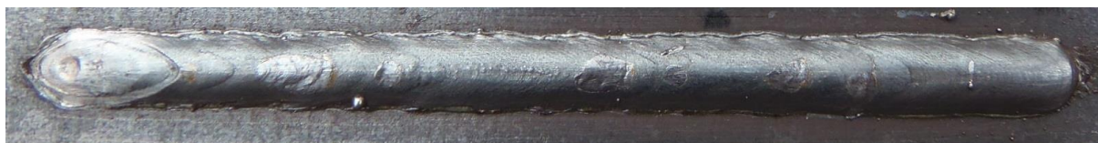
Obr. 34 Housenka č. 8 – směr vpřed, přechodový přenos
