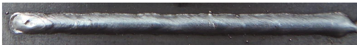
Obr. 48 Housenka č. 10 – směr kolmý, zkratový přenos
