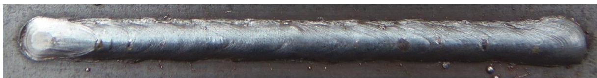
Obr. 46 Housenka č. 9 – směr kolmý, impulzní přenos
