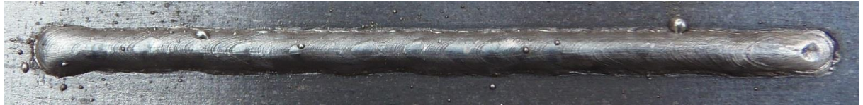
Obr. 36 Housenka č. 2 – směr vzad, zkratový přenos
