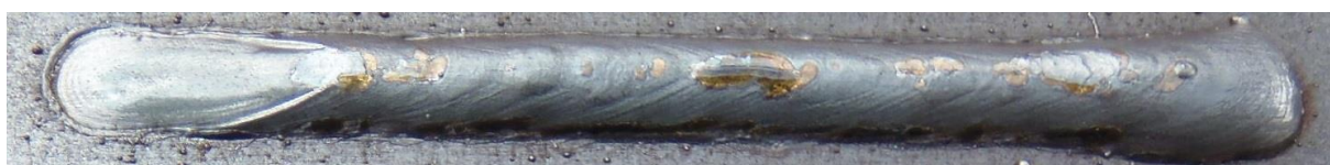
Obr. 52 Housenka č. 12 – směr kolmý, impulzní přenos
