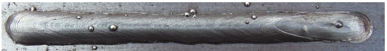
Obr. 38 Housenka č. 3 – směr vzad, sprchový přenos
