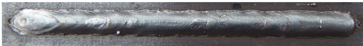
Obr. 34 Housenka č. 8 – směr vpřed, přechodový přenos
