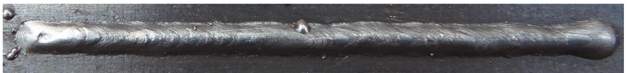
Obr. 28 Housenka č. 1 – směr vpřed zkratový přenos
