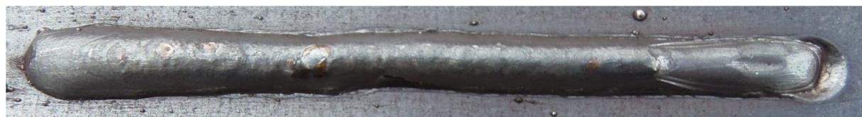
Obr. 40 Housenka č. 6 – směr vzad, impulzní přenos
