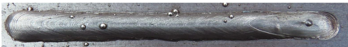
Obr. 38 Housenka č. 3 – směr vzad, sprchový přenos
