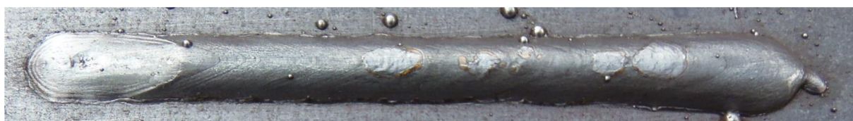
Obr. 32 Housenka č. 5 – směr vpřed, přechodový přenos
