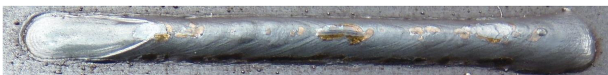
Obr. 52 Housenka č. 12 – směr kolmý, impulzní přenos
