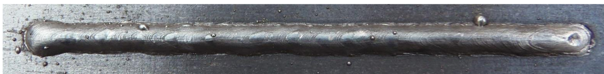
Obr. 36 Housenka č. 2 – směr vzad, zkratový přenos
