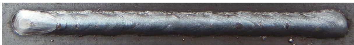
Obr. 46 Housenka č. 9 – směr kolmý, impulzní přenos
