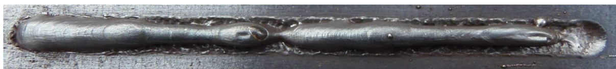
Obr. 43 Housenka č. 7 – směr vzad, impulsní přenos
