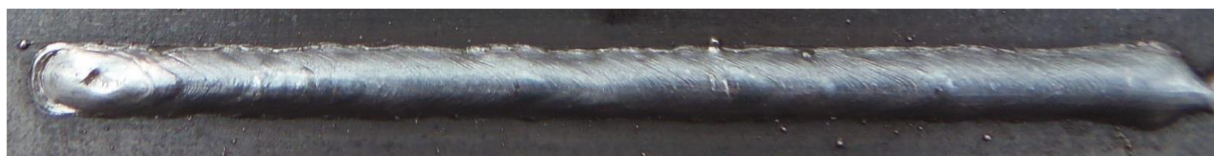
Obr. 48 Housenka č. 10 – směr kolmý, zkratový přenos
