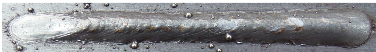
Obr. 30 Housenka č. 4 – směr vpřed, přechodový přenos
