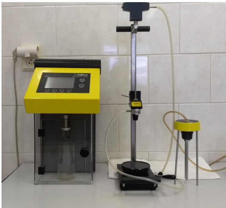
Obrázek 16: Příklad přístroje na měření stability pивní pěny NIBEM-T (zleva NIBEM-T, Inpack 2000 Sampler, Inpack 2000 Flasher)
