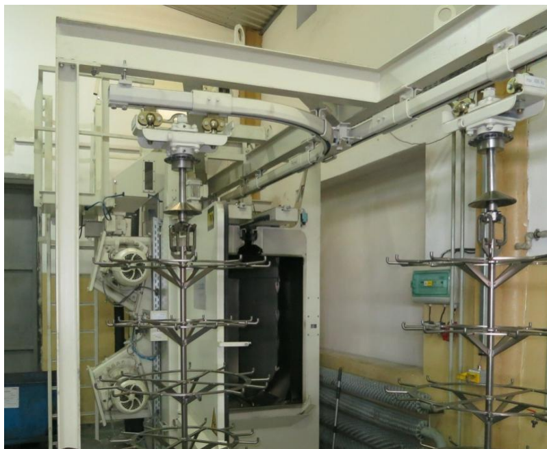
Obr. 9 Komora tryskače; polotovar hlavy-odlitek
