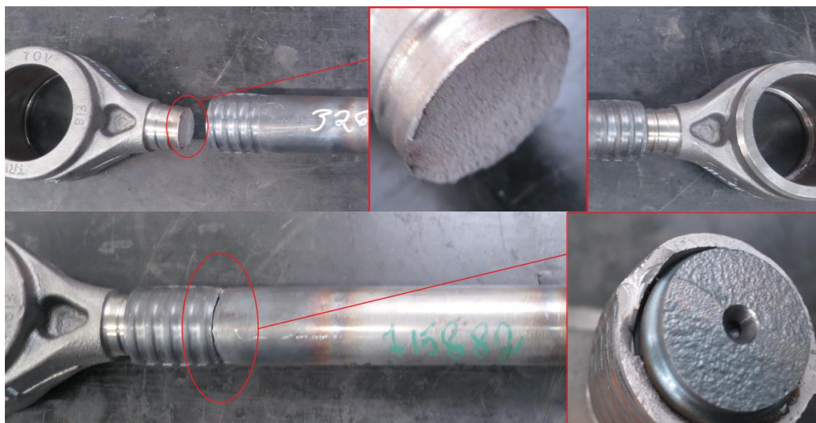
Obr. 50 Příklady únavových lomů táhel (na dříku-neplatný; na trubce)
