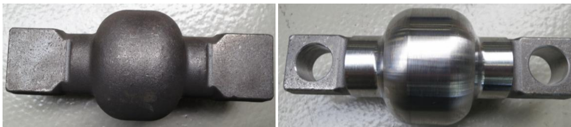
Obr. 11 Polotovár čepu-výkovek a obroběný čep pro pogumování
