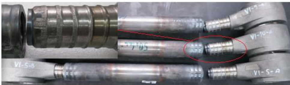
Obr. 43 Vzorky po přetržení (50x6-4 drážky)
