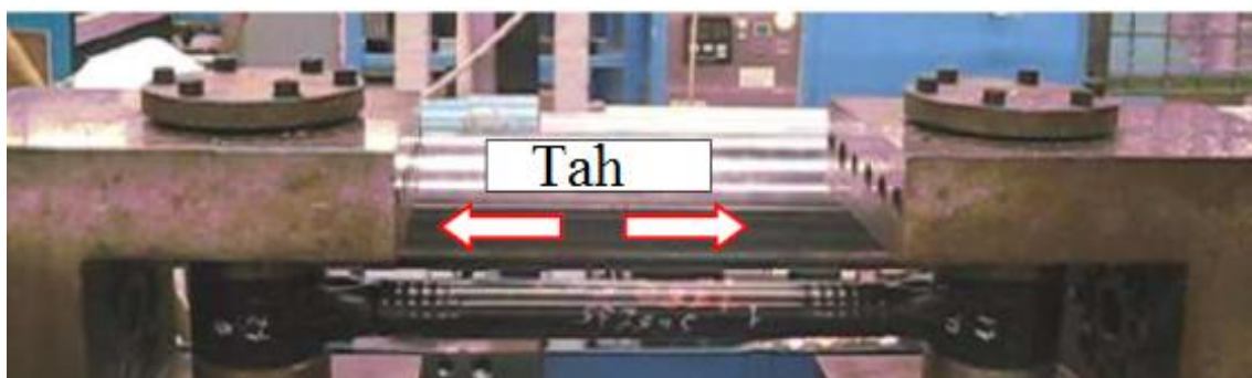
Obr. 36 Upnutí táhla při zkoušce tahem
