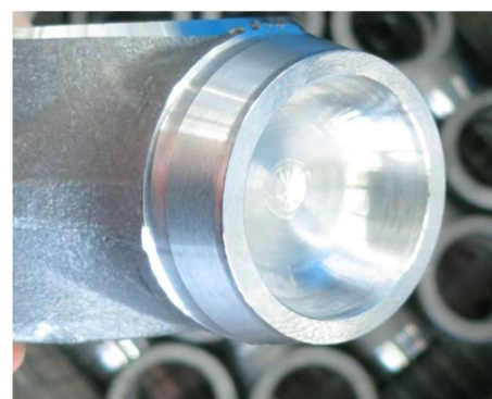
Obr. 12 Tvar obroběný pro svařování
