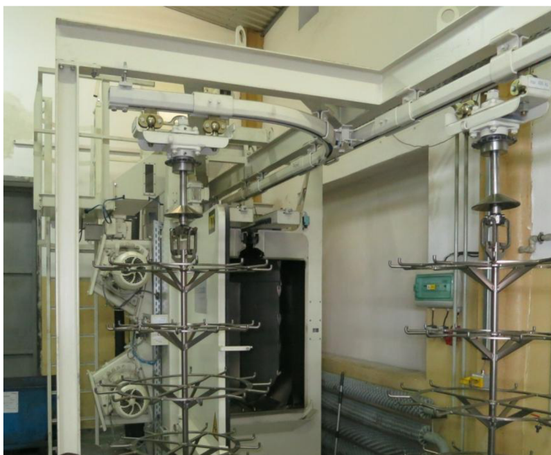
Obr. 9 Komora tryskače; polotovar hlavy-odlitek
