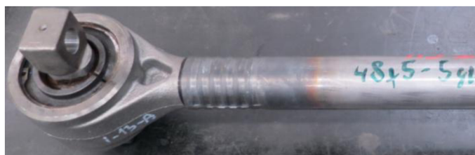
Obr. 38 Ocelový kloub pro testy
