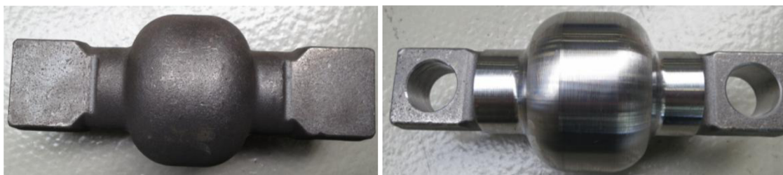
Obr. 11 Polotovár čepu-výkovek a obroběný čep pro pogumování
