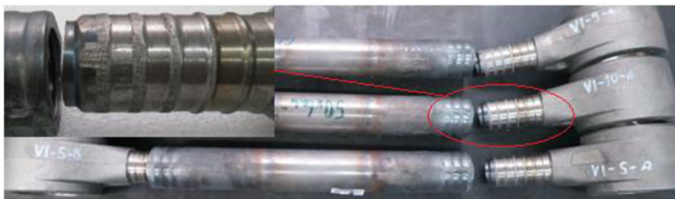
Obr. 43 Vzorky po přetržení (50x6-4 drážky)
