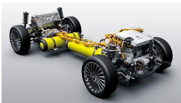
Obr. 26 Toyota Mirai II – pohonná jednotka [49]
