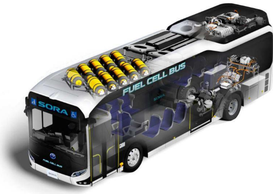
Obr. 30 Toyota Sora – umístění jednotlivých komponentů [58]
