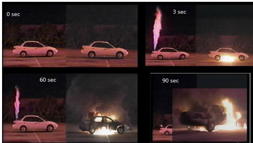
Obr. 3 Porovnání bezpečnosti vodíkové a benzínové nádrže při cíleném zapálení [20]
