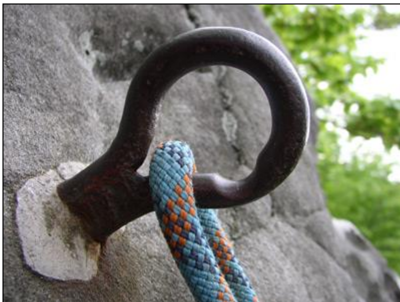
Obr. 14: Ukázka probroušeného vrcholového kruhu od posunujícího se lana. (Horolezecká metodika 2016)
