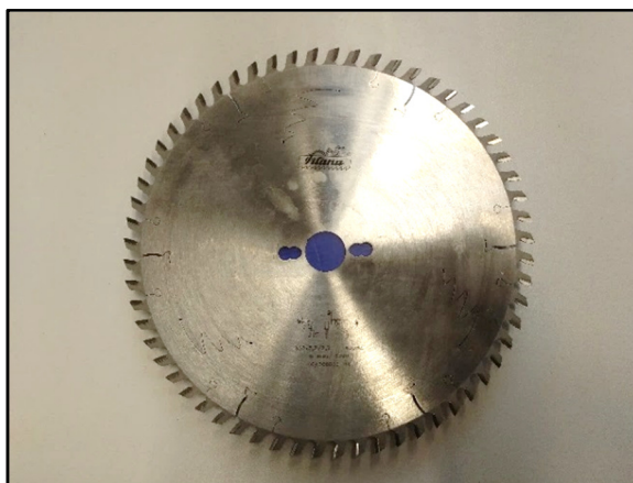
Obrázek 8: Speciální kotouč na laminované desky bez použití předřezové jednotky (autorka)
