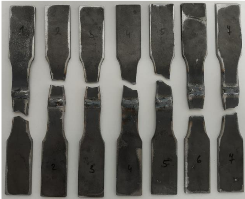
Obrázek 6.4 Přetržené zkušební tyče
