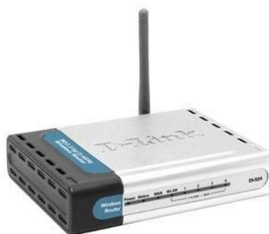
Obrázek 4 - Běžný amatérský přístupový bod [5]
