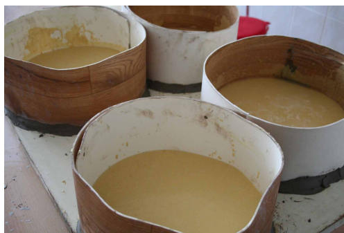
Obr. 58. Vytváření sádrových forem
