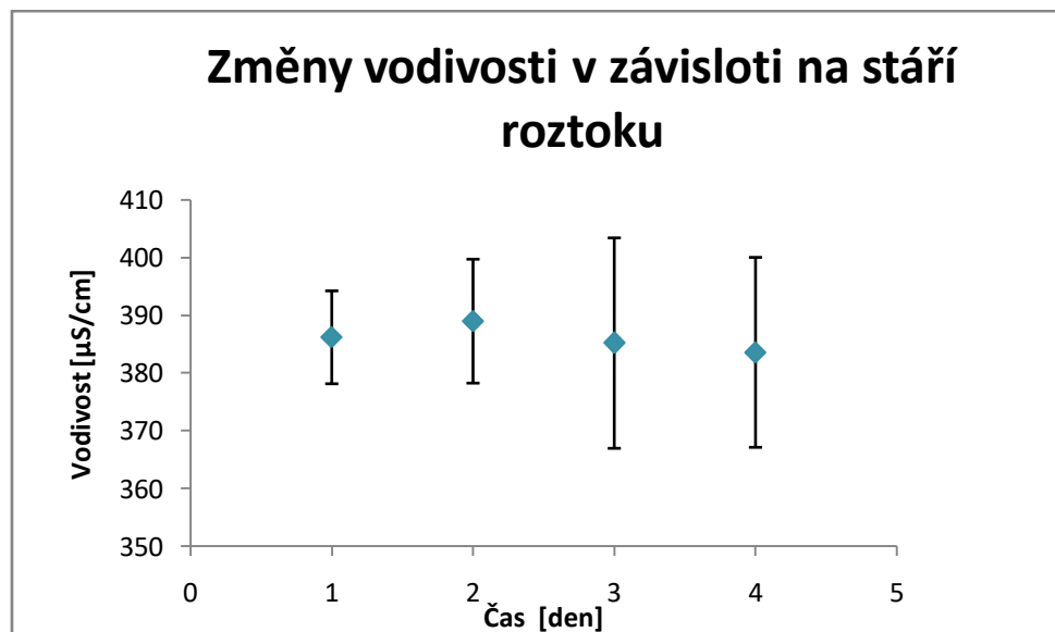
Obrázek 17: Změny vodivosti v závislosti na stáří roztoku (vodivost při 22,5 °C; roztok: 12% PA6 + 0,5 hm% AgNO 3 )
