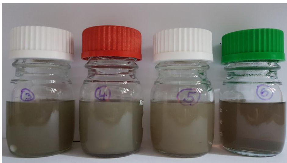
Obrázek 15: Stárnutí roztoku v jednotlivých dnech; zleva 4 dny, 3 dny, 2 dny (zredukováné roztoky) , vpravo 1 den starý roztok (nezredukováný)
