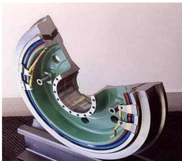
Obrázek 3: Řez skládaným tramvajovým kolem, převzato z [7]
