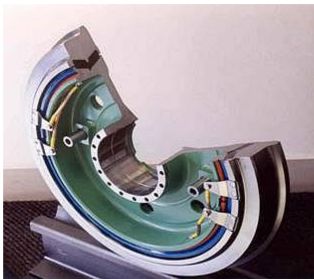
Obrázek 3: Řez skládaným tramvajovým kolem, převzato z [7]
