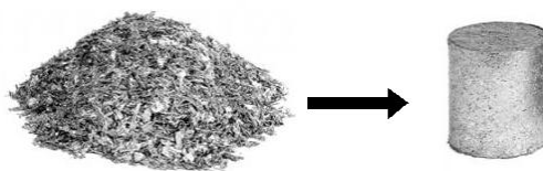
Obr. 5.3 Ukázka briketování hliníku [41]
