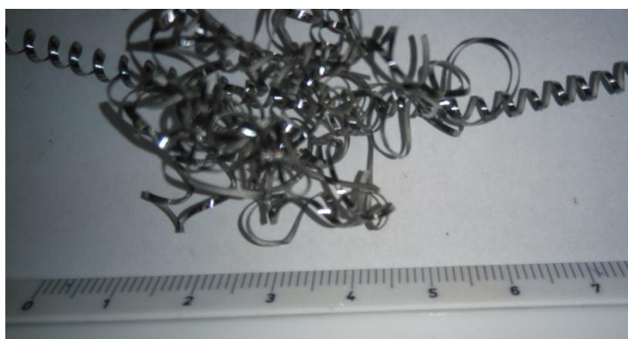
Obr. 3.12 Tříška při obrábění břitovou destičkou 3
