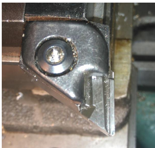
Obr. 3.3 Vyměnitelná břitová destička v držáku
