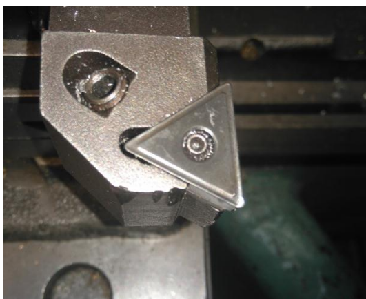
Obr. 3.5 Vyměnitelná břitová destička v držáku
