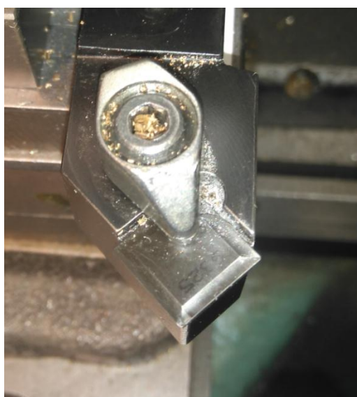
Obr. 3.1 Vyměnitelná břitová destička v držáku
