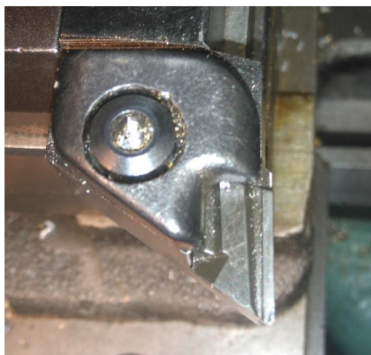
Obr. 3.3 Vyměnitelná břitová destička v držáku
