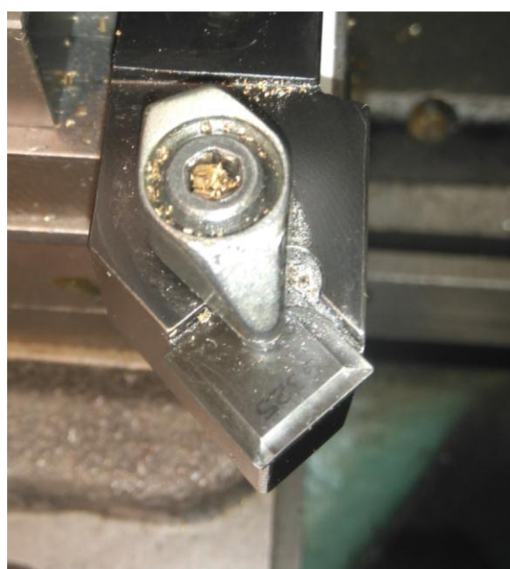
Obr. 3.1 Vyměnitelná břitová destička v držáku
