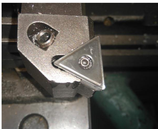
Obr. 3.5 Vyměnitelná břitová destička v držáku
