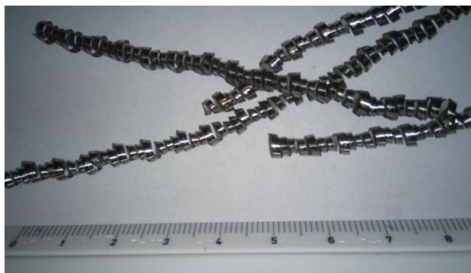
Obr. 3.10 Tříška při obrábění břitovou destičkou 1
