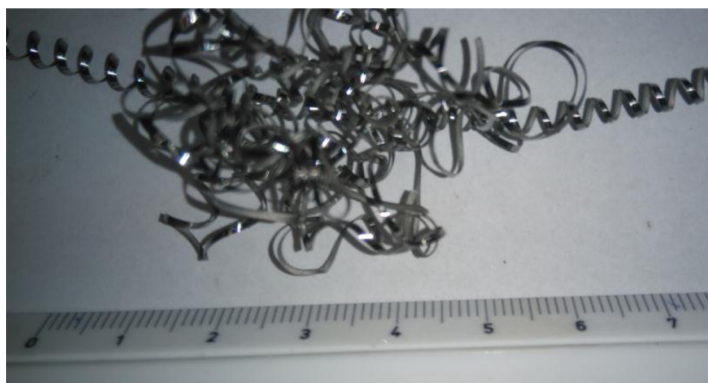
Obr. 3.12 Tříška při obrábění břitovou destičkou 3
