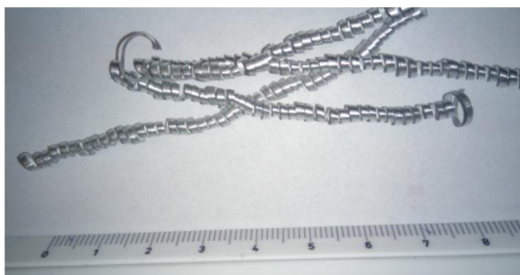
Obr. 3.7 Tříška při obrábění břitovou destičkou 1
