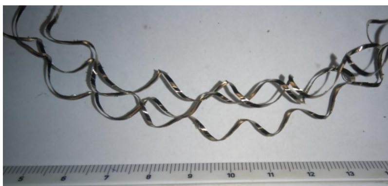
Obr. 3.20 Tříska při obrábění břitovou destičkou 3
