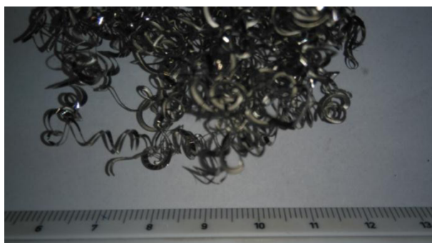
Obr. 3.18 Třísky při obrábění břitovou destičkou 1
