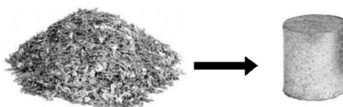
Obr. 5.3 Ukázka briketování hliníku [41]
