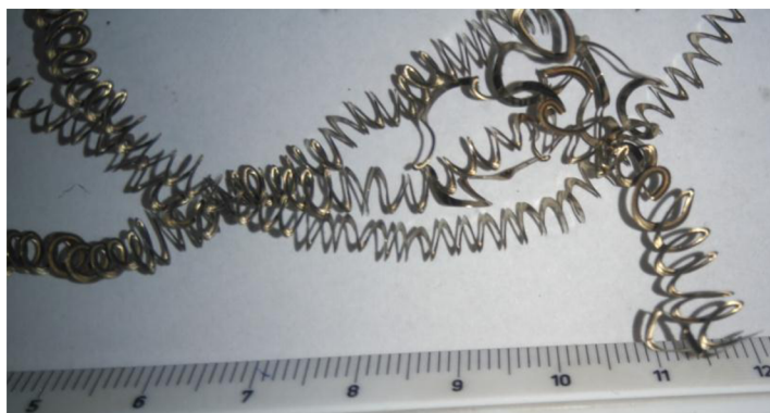
Obr. 3.19 Tříska při obrábění břitovou destičkou 2
