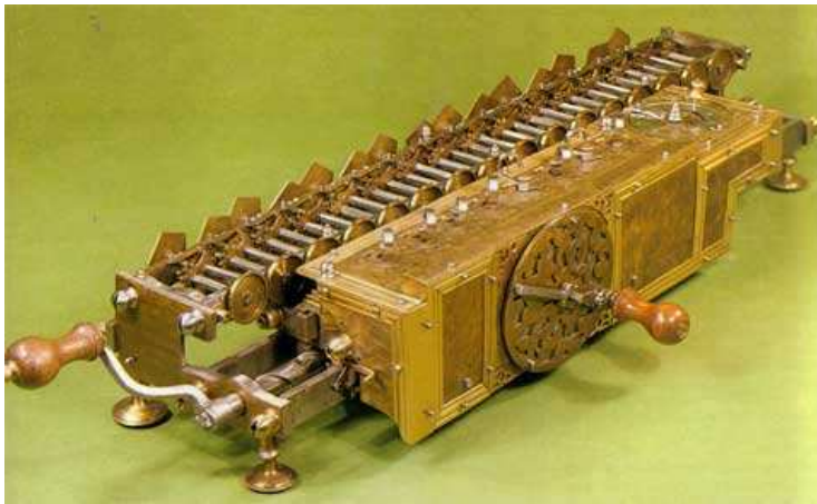
Obr. 23 Replika krokového kalkulátoru
