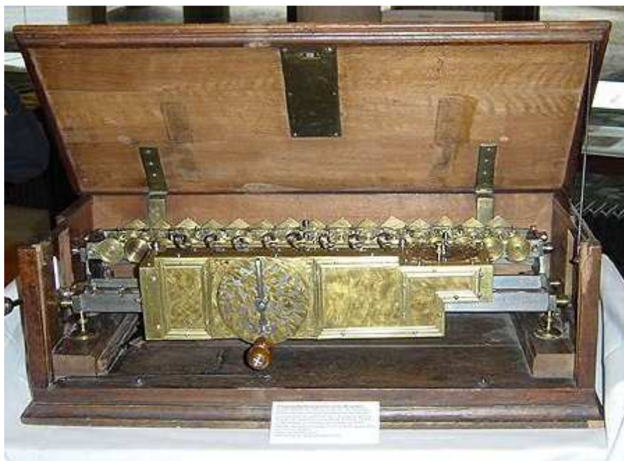
Obr. 24 Leibnizův kalkulátor v dřevěném boxu
