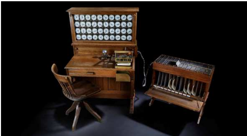
Obr. 62 Replika Hollerithova prvního mechanického tabulátoru (děrovačka, kontaktní mechanismus, čítače a třídiče)
