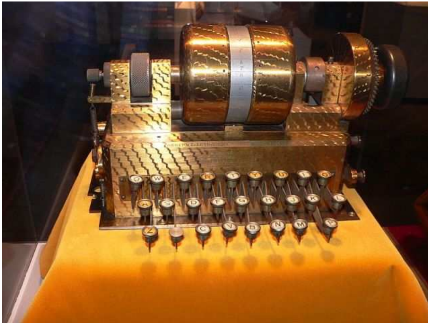
Obr. 85 Jedno-rotorový šifrovací stroj
