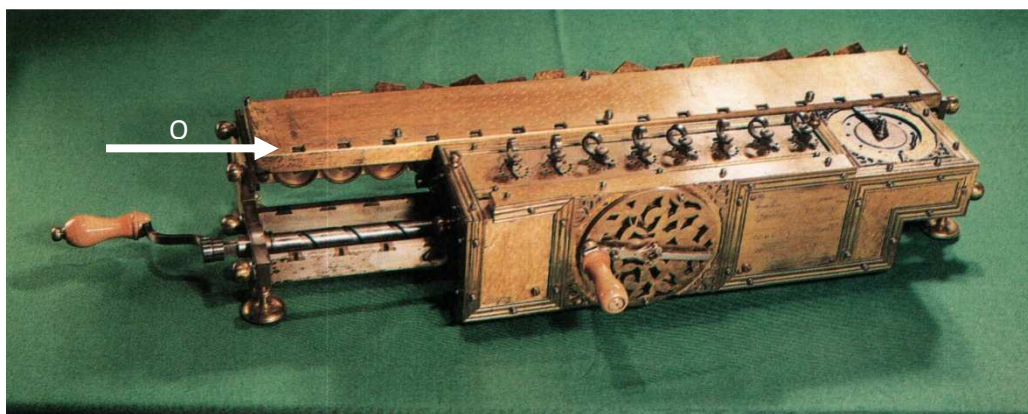
Obr. 26 Replika Leibnizova kalkulátoru
