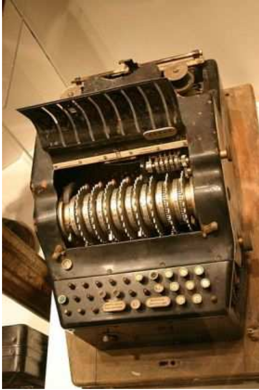
Obr. 91 Enigma II - 8-rotorový model
