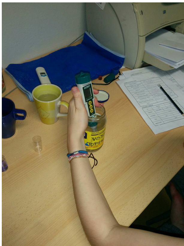
Obrázek 30 Měření Conductivity/TDS metrem
