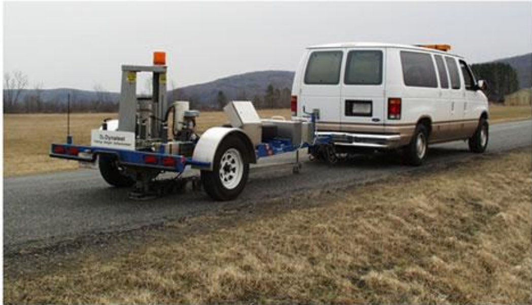
Obr. 7 Příklad rázového zatěžovacího zařízení (FWD)
