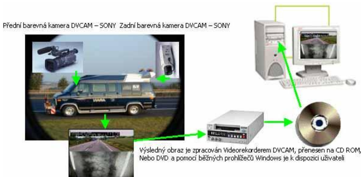
Obr. 5 Sběr dat prováděný videozáznamem
