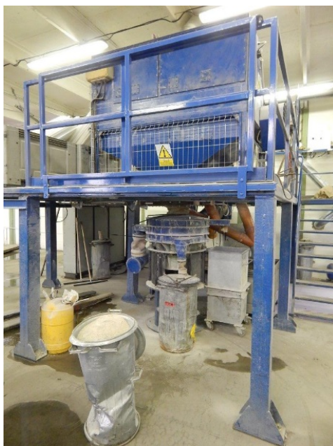
Obr. 14: Část linky pro zpracování lineárních zářivek ( zdroj: vlastní )
