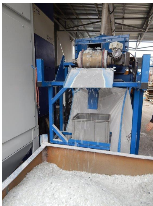
Obr. 15: Sklo padající z vibračního třídiče přes magnetický separátor do připraveného kontejneru ( zdroj: vlastní )
