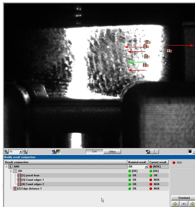
Obr. 4.9 Špatně založený otočný mechanismus.
