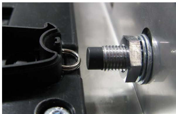
Obr. 3.6 Detekce kovového kroužku
