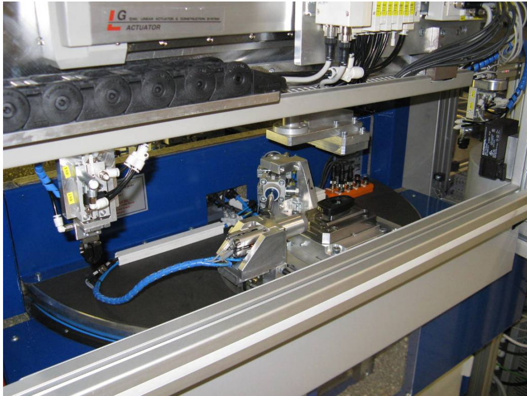
Obr. 4.31 Stanice vibračního svařování
