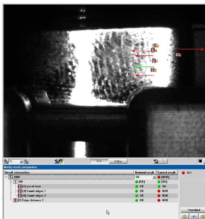
Obr. 4.9 Špatně založený otočný mechanismus.
