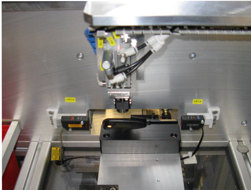
Obr. 4.35 Vkládací lože – stanice Leaktestu a Torqtestu.
