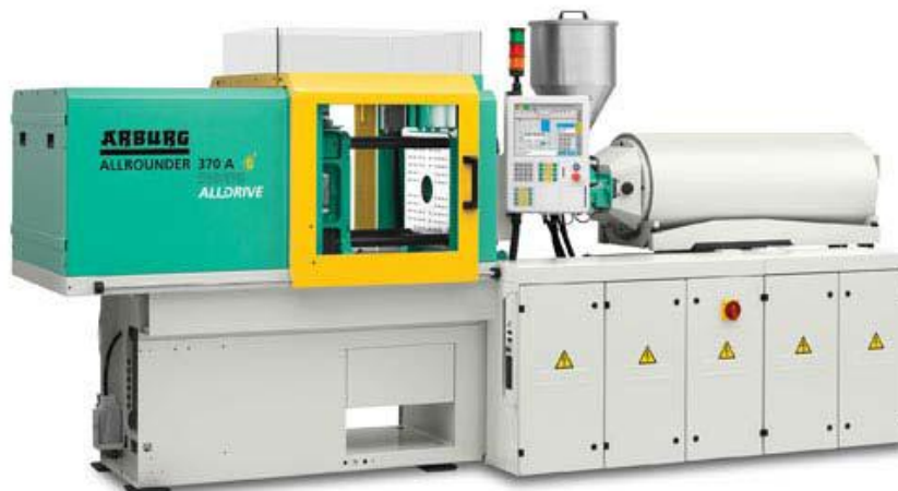
Obr. 7.10 Vstřikovací lis Arburg Allrounder 370A [Příloha č. 3]
