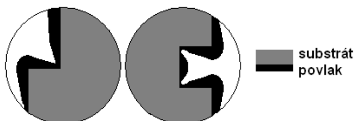
Obr. 4.2. Rovnoměrnost tloušťky kovového povlaku při galvanickém pokovení[23]
