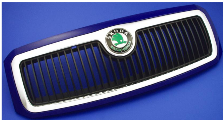
Obr. 7.1 Ukázka užití materiálu Terluran® GP-35, mřížka i pokovený emblém [10]
