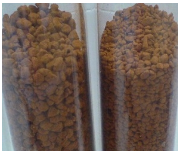
Obrázek 3.7: Filtrační materiál CFH 12 v koloně [8]
