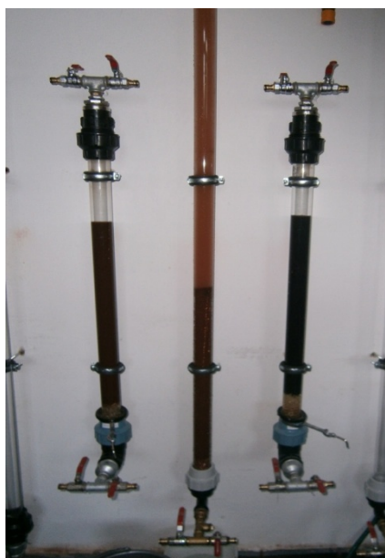
Obrázek 4.1: Modelové zařízení filtrační kolony
