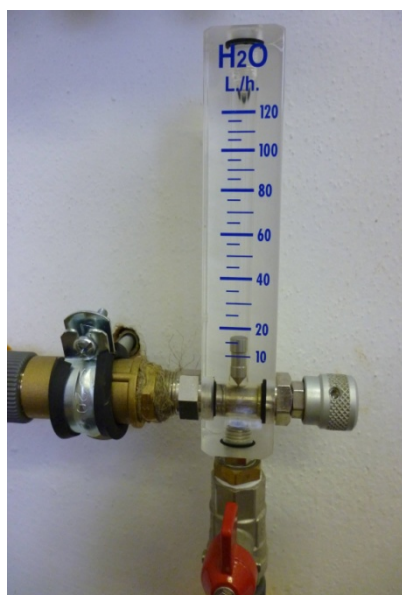
Obrázek 4.2: Rotametr s ventilem na přítoku
