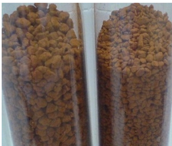
Obrázek 3.7: Filtrační materiál CFH 12 v koloně [8]
