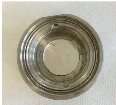
Obrázek 13: Vyroběný elektrochemický článek s elektrodou LTO v měřicí cele
