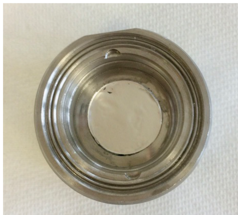
Obrázek 13: Vyrobený elektrochemický článek s elektrodou LTO v měřicí cele
