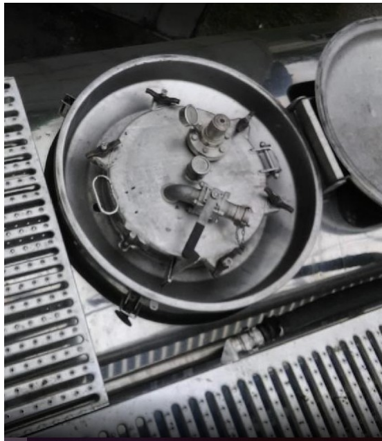
Obr. 4.1 Cisterna s ovládáním ventilů nahoře
