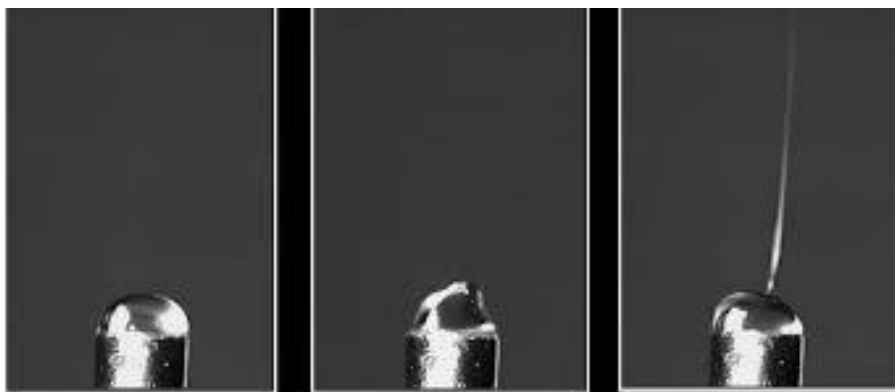
Obr. 2 Vznik nanovláken (nestabilita polymeru a vznik trysky spolu s vláknem) [4]
