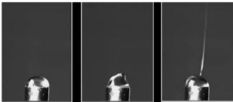
Obr. 2 Vznik nanovláken (nestabilita polymeru a vznik trysky spolu s vláknem) [4]
