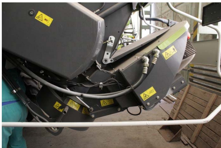
Obrázek 27 Zadní část mlátičky (výstup slámy)
