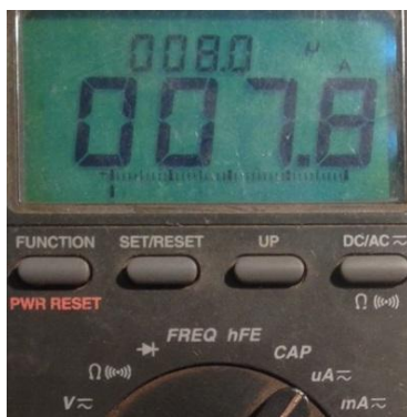
Obr. 0-8 Měření průměrné spotřeby energie senzového modulu pomocí měřicího přístroje METEX měření varianty D
