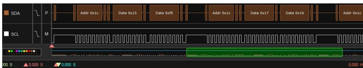
Obr. 3-9 Komunikace I2C mezi EFM332 a akcelerometrem MMA8451
