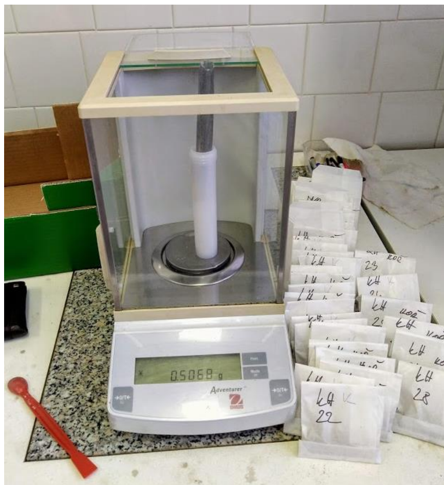
Obrázek 18. Příprava kyvet na nízkotlaký rozklad
