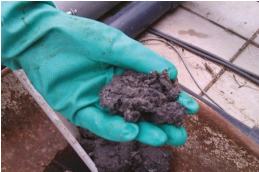
Obrázek 6.2 Odvodněná směs kalu a buničiny, ČOV Ulrum, Nizozemsko [20]
