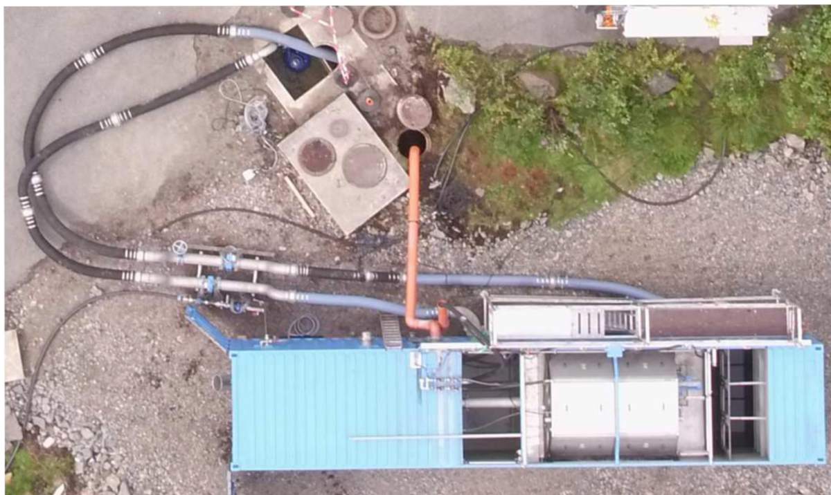
Obrázek 7.8 HUBER Drum Screen LIQUID pohled shora, měření č. 1, Německo [22]
