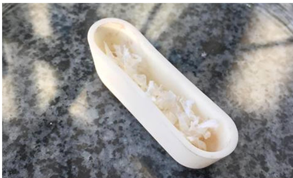
Obrázek 8.4 Vzorek umístěný ve vzorkovací lodi
