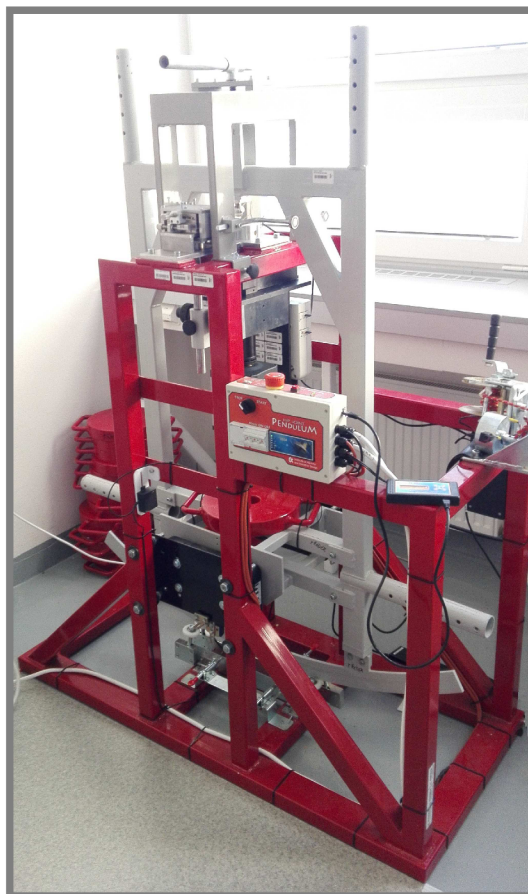
Obr. 4.3 Experimentální zařízení využívající fluorescenční mikroskopie
