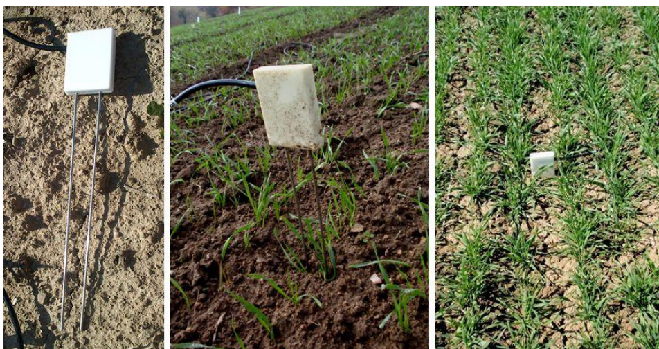
Obr. 14: TDR senzor umístěný v polním pokusu MENDELU v Domanínku v roce 2012.
