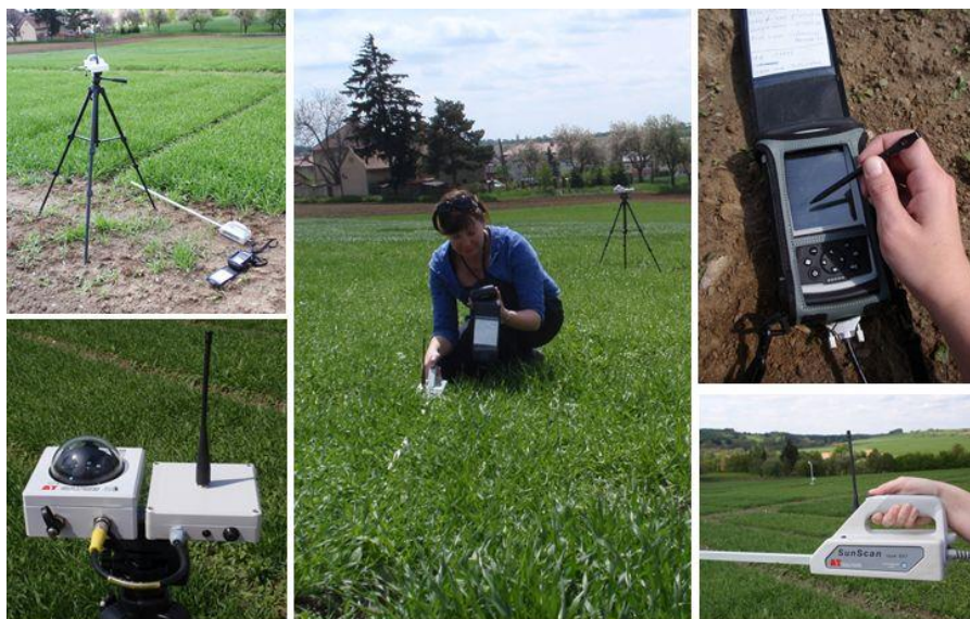
Obr. 11: Měření LAI pomocí přístroje SunScan v polním pokusu s ječmenem jarním MENDELU v Domanínku v roce 2014.
