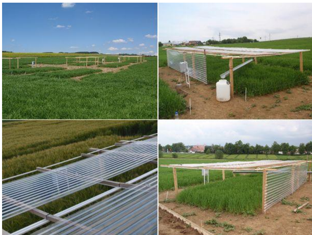
Obr. 23: Polní pokus MENDELU s ječmenem jarním odrůdou „Bojos“ a experimentálními zákryty pro redukci srážek zakrývající 70 % pokusné parcely v Domanínku v roce 2014.
