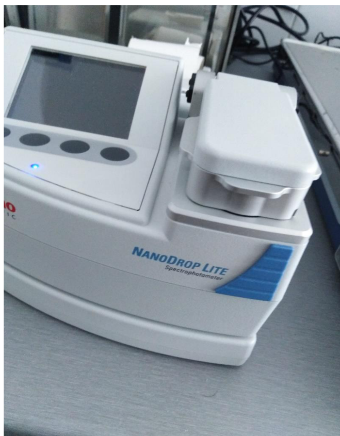
Obrázek 6: Spektrofotometr NanoDrop Lite, který byl využit k měření koncentrace produktu
