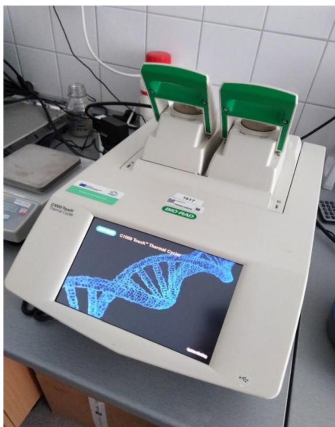
Obrázek 2: Příklad přístroje C1000 Touch Thermal Cycler, využitý pro PCR
