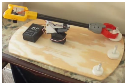
Obr. 3 a) Rob. rameno s více stupni volnosti; b) Manipulátor se 2 stupni volnosti
